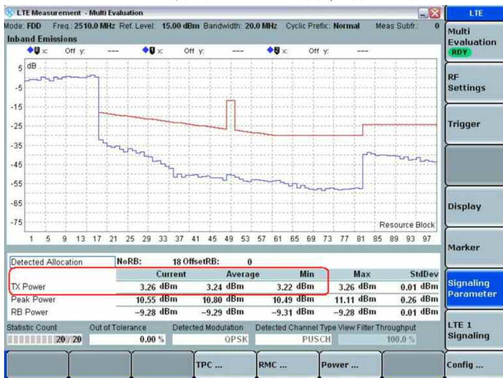
图. 59: Test Set 1 带内杂散测量结果.
