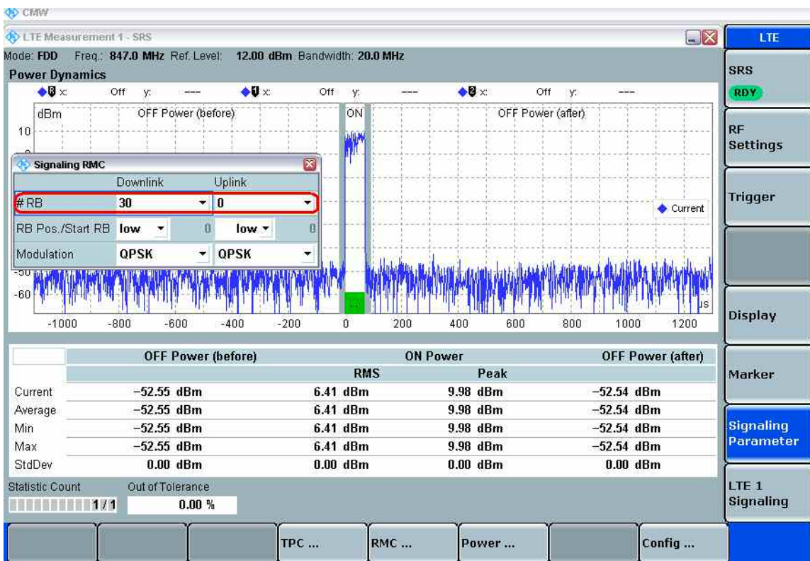
a) FDD 模式下 SRS 的测量结果
