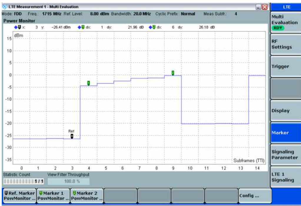
a) FDD 终端一帧测量结果，包括RB 变化
