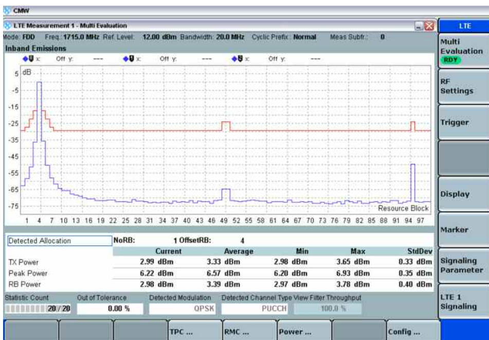
图. 61: PUCCH 带内杂散测量结果
