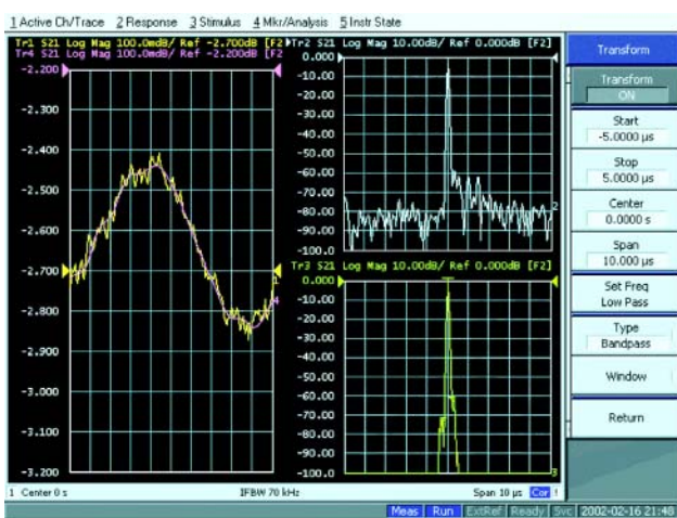
使用时域和门控功能去除 SAW 滤波器的 TTE
