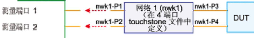
将 DUT 连接到分析仪上的 3 个端口（布局 B）时
